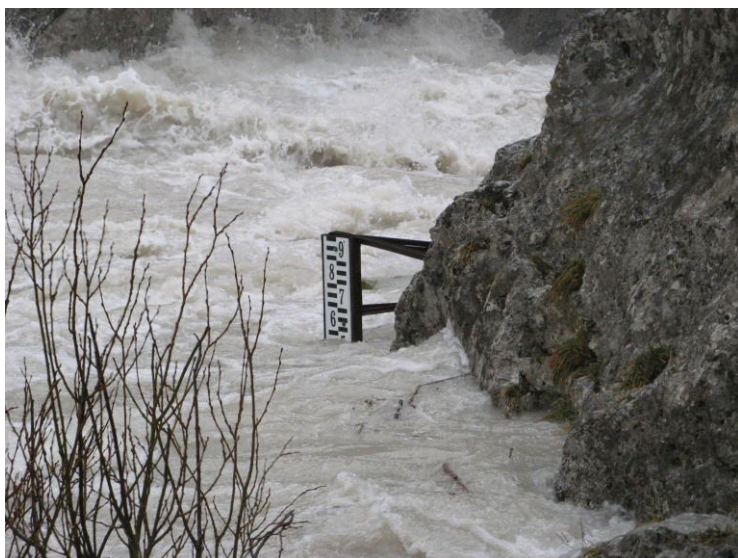
Slika 4. Vodometro mesto Soča Kobarid v času visokih voda novembra 2012. Odčitavanja vodostajev na vodomerni letvi so ob visokih vodah otežena zaradi turbuletnega toka v strugi Soče pri Kobaridu (foto: arhiv ARSO) Figure 4. Solkan upstream above the gauging station Soča Solkan (Photo: ARSO archive)
