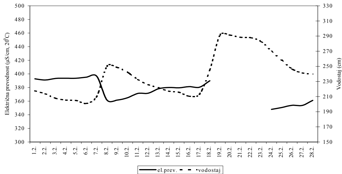
Slika 5.5. Povprečne dnevne vrednosti električne prevodnosti in vodostaja na postaji Sava Hrastnik v februarju 2002 Figure 5.5. Average daily values of conductivity and level at station Sava Hrastnik in February 2002
