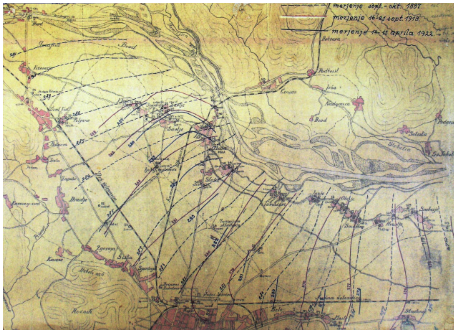
Slika 1. Hidrogeološka karta gladine podzemne vode na Ljubljanskem polju v letih 1887, 1918 in 1922 Figure 1. Groundwater contour map of Ljubljansko polje aquifer water tables in 1887, 1918 and 1922
