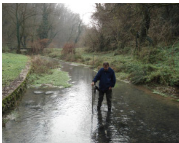
Slika 1. Izvajanje hidrometričnih meritev na izviru Metliški Obrh (21. november 2007)
