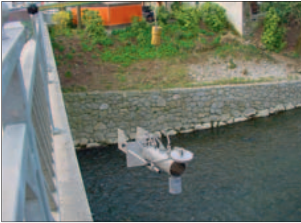
Odvzem vzorca z batometrom (foto: Florjana Ulaga). Suspended material water sampler (Photo: Florjana Ulaga).
